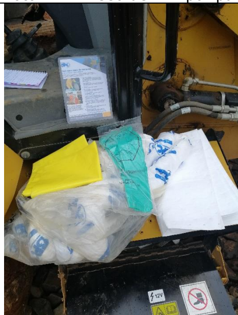
Foto N° 15. Kit de atención de derrame en equipos y oficinas de subcontratista de movimiento de tierra
