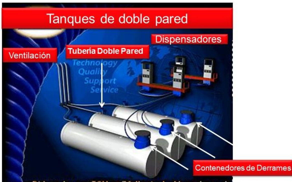
Fuente: Promotor del Proyecto Figura 2. Configuración de los Tanques
