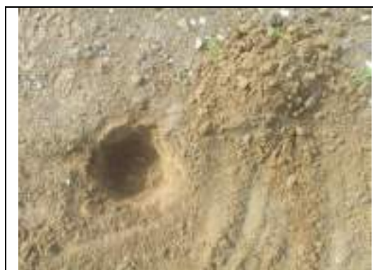
Foto No. 16: Sondeo Nº 1 De 0 a 5 cm. Material de relleno: gravilla y tosca.
