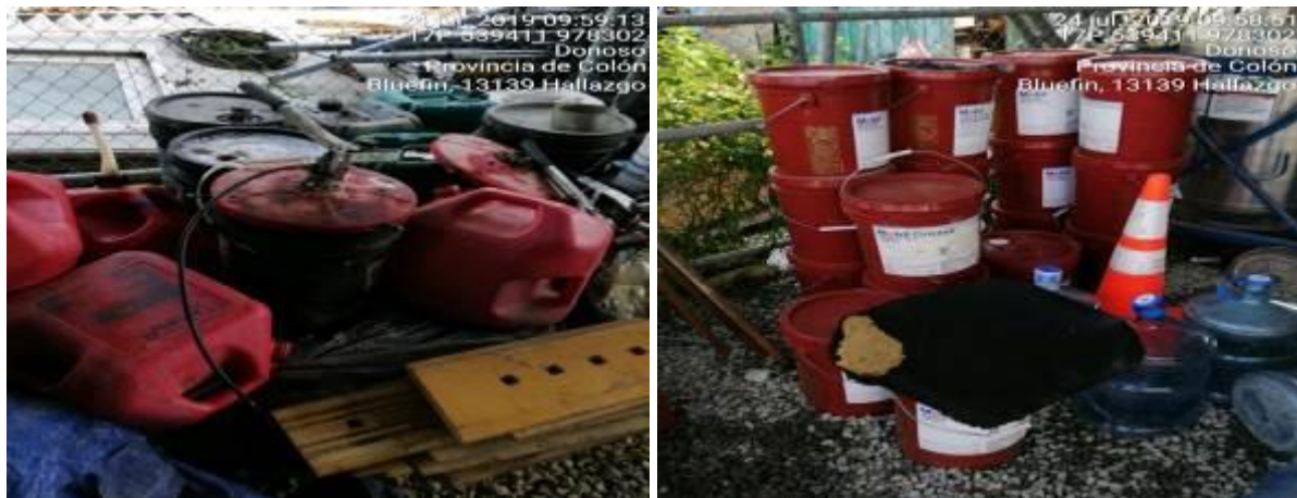
Imágenes 336 y 337. Recipientes con gasolina y tanques de lubricantes en el Taller de Bluefin, sin bandeja de contención (978302 N/ 539411 E)
