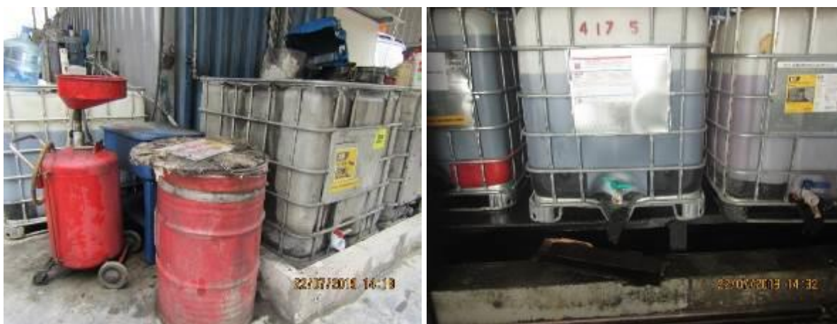
Imágenes 330 y 331. Ausencia de contencion secundaria en Taller de Mantenimiento de Equipos Livianos (978747 N/ 538344 E) y Taller de grúas (978694 N/ 538422 E)
