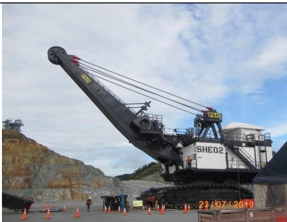
Imágenes 262 y 263. Pala Komatsu P&H con capacidad de balde de 120 toneladas (977230 N/ 538766 E) y camiones en el ciclo de carga y transporte del Tajo Botija (977587 N/ 537332 E)
