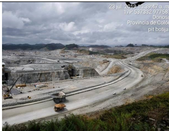
Imágenes 262 y 263. Pala Komatsu P&H con capacidad de balde de 120 toneladas (977230 N/ 538766 E) y camiones en el ciclo de carga y transporte del Tajo Botija (977587 N/ 537332 E)
