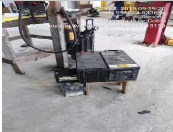
Imágenes 342 y 343. Ausencia de contención secundaria en el Taller de mantenimiento Ultraclase (978395 N/ 539359 E) y Taller mecánico de equipo liviano Punta Rincón (996014 N/ 533694 E)
