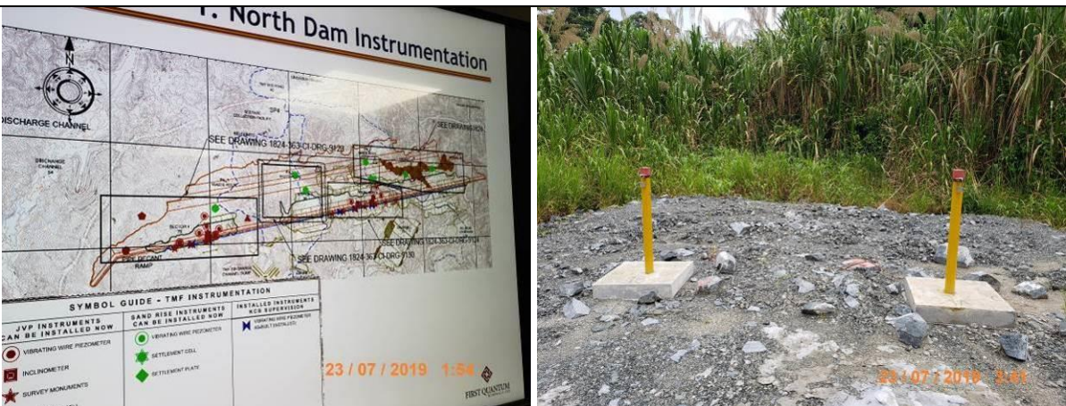
Imágenes 365 y 366. Distribución de pozos de monitoreo de la Presa Norte y tipos de instrumentación utilizada en la IMR, pozos de monitoreo (983266 N/ 538682 E)
