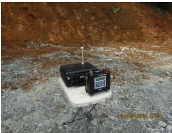
Imágenes 2.2.5 y 2.2.6. Monitoreo de calidad de aire ( PM_{10} ) y emisiones gaseosas en Presa Este de la IMR (Plataforma 3), 980995 N/ 538865 E
