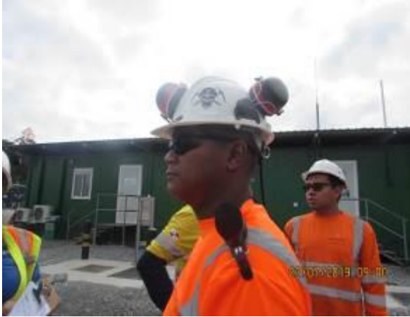
Imágenes 2.4.5 y 2.4.6. Monitoreo de ruido laboral en Planta de Procesos (Área de trituración secundaria, área 313), 978741 N/ 539430 E
