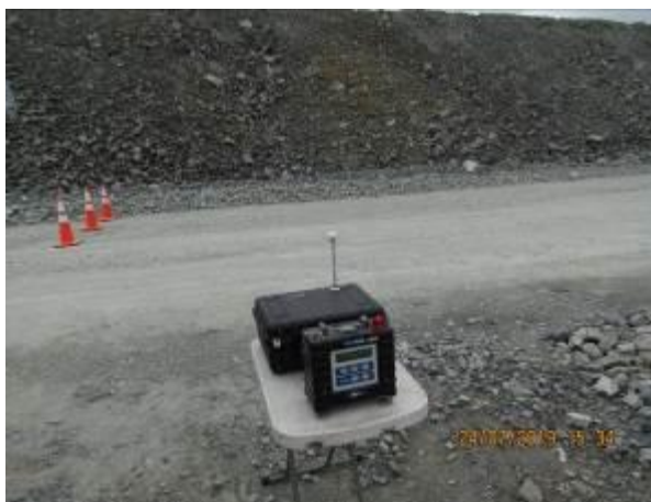
Imágenes 2.2.9 y 2.2.10. Monitoreo de calidad de aire (PM 10 ) y emisiones gaseosas en Pre-Stripping del tajo Botija (Carita de Acceso), 978121 N/ 537332 E
