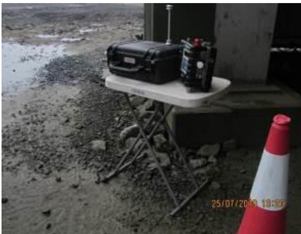
Imágenes 2.2.13 y 2.2.14. Monitoreo de calidad de aire ( PM_{10} ) en Área de almacenamiento de Concentrado de Cobre, 996494 N/ 533819 E
