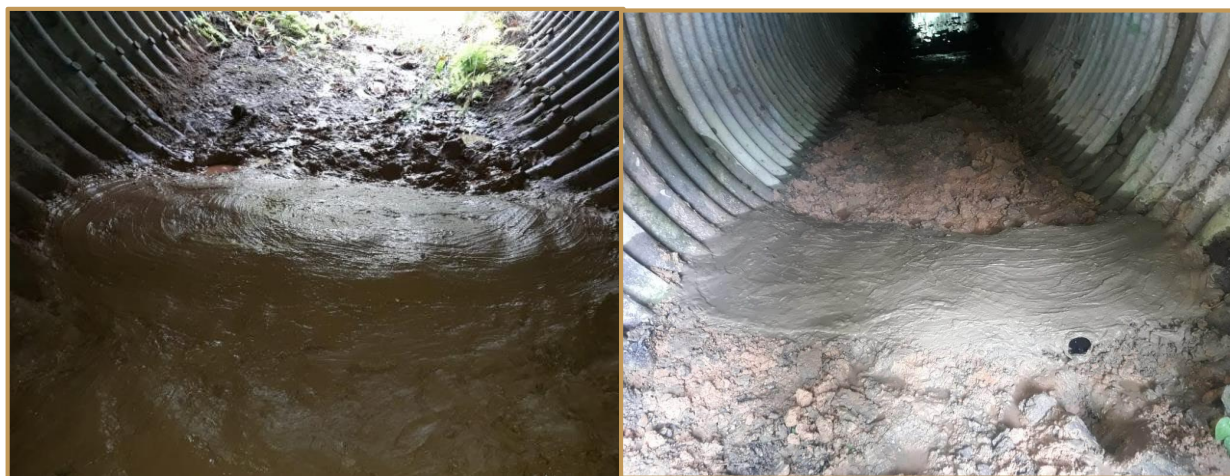
Figura N°2. Algunas de las trampas de lodo instaladas en los extremos de las estructuras de cruce de fauna, las mismas son monitoreadas durante 45 días en la estación lluviosa. Durante los eventos de cruce de un animal se registran las huellas en una base de datos. La trampa se adecua para que ninguna huella quede marcada y se pueda traslapar información de los registros diarios.
