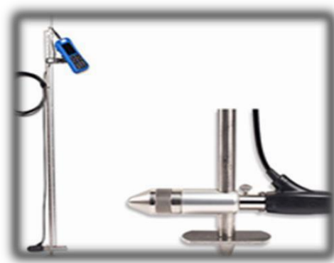
Figura No. 1: Capacitación en el uso del equipo; componentes del OTT MFpro Fuente: Departamento de Monitoreo Ambiental
