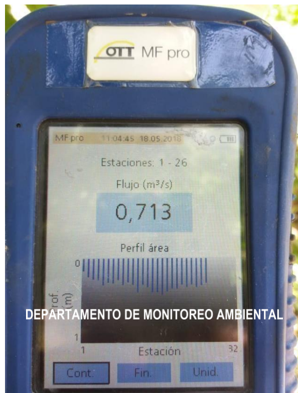
Figura No. 2: Pantalla del OTT MFpro con la opción “resumen de mediciones” Fuente: Departamento de Monitoreo Ambiental
