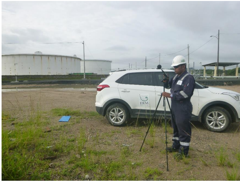
Fotografía 5: Instalación del equipo de medición de ruido en punto 2.
