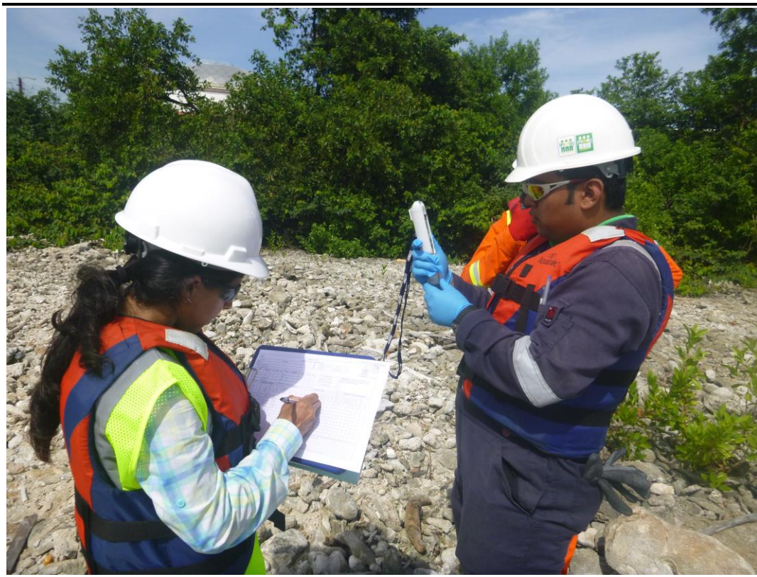
Figura 2 Análisis de parámetros de campo para determinación de calidad de agua de mar
