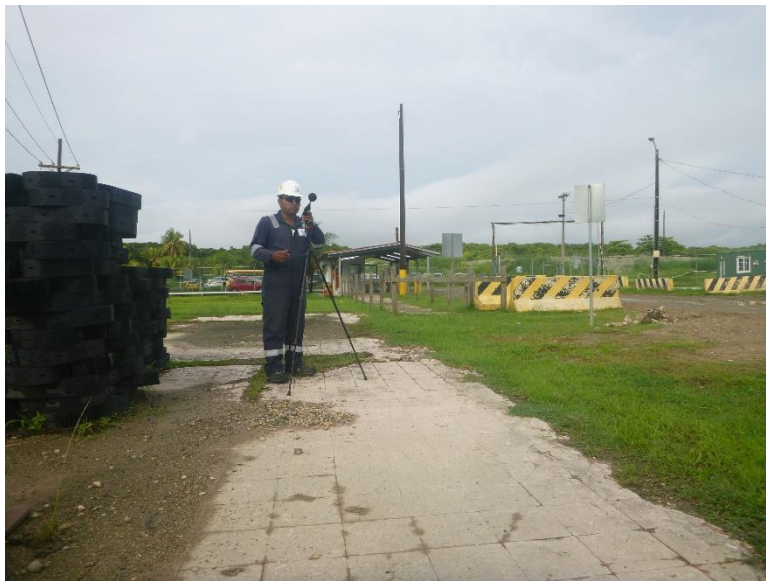
Fotografía 1: Revisión y calibración del equipo de medición de ruido SVAN 971.
