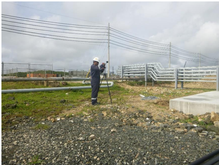
Fotografía 5: Instalación del equipo de medición de ruido en punto 2.
