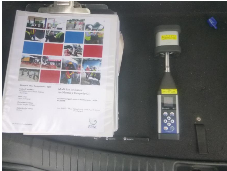
Fotografía 1: Revisión y calibración del equipo de medición de ruido SVAN 971.
