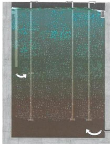
Un compresor de aire de tipo de desplazamiento positivo estará localizado fuera de la planta y conectará a los difusores *FlexAir* mediante un arreglo, que permita el fácil reemplazo de los elementos, sin necesidad de vaciar la cámara de aireación.
