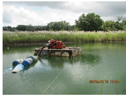
Tina de sedimentación y abastecimiento de agua para mitigación en el proceso de trituración y molienda.
