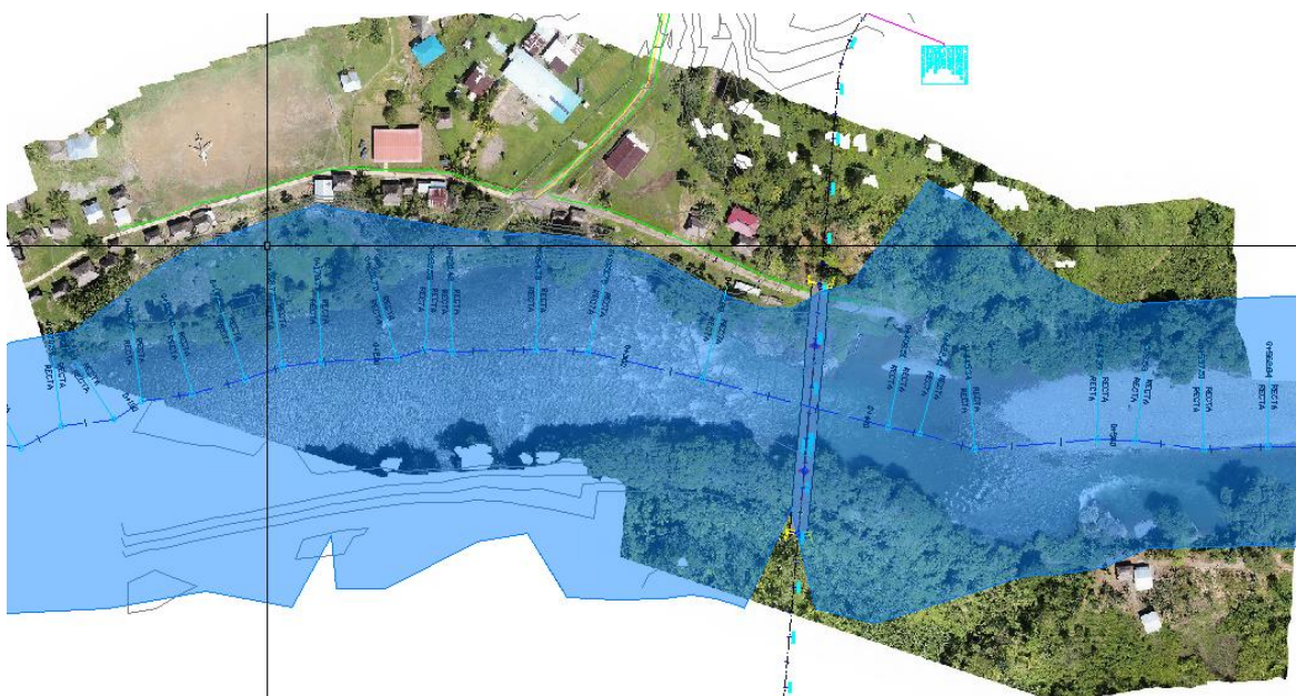
Imagen n° 1. Lámina inundación sin estructura Q100 años (marcada en azul) y viviendas próximas al cauce
