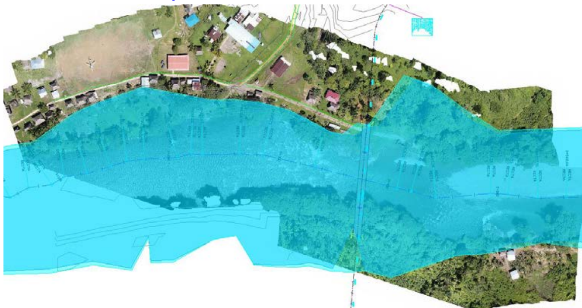
Imagen n° 5. Lámina inundación con estructura 100 m Q100 años
