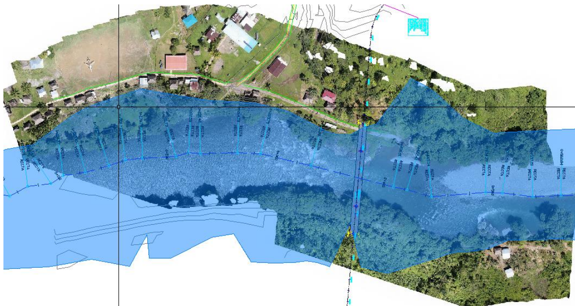
Imagen n° 4. Lámina inundación sin estructura Q100 años
