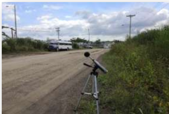
Fotografía 8. Sonómetro para toma de datos de ruido ambiental en el área del proyecto.
