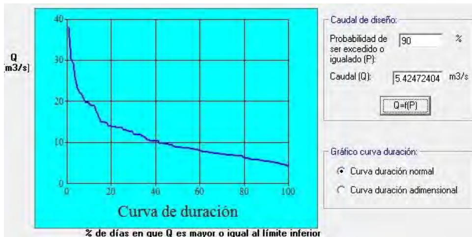
Figura #9. Curva de duración para época seca (ene-abr) en el Proyecto (río Guarumo)
