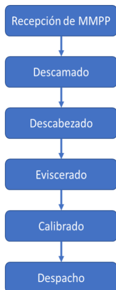
Figura 11) Diagrama de proceso de la planta primaria
