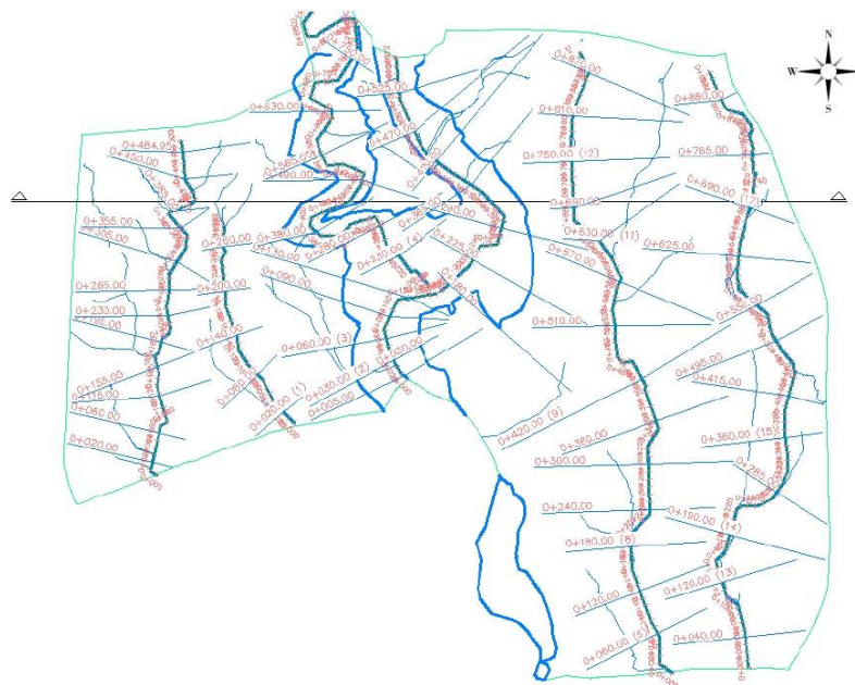
Figura 9-1. Secciones transversales generadas en AutoCad Civil 3D®
