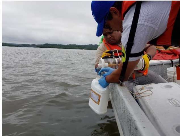
Fig. 4. Ejemplo de llenado de los envases de las muestras. Botella de plástico usada para sólidos (S.T., S.D., etc.)
