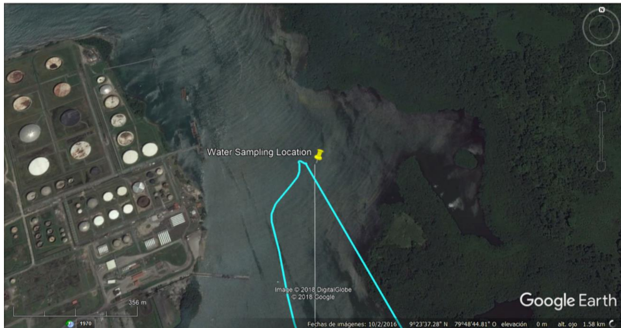
Fig. 2. El pin amarillo indica el sitio de la toma de muestra, la línea azul es el seguimiento por GPS con 20 m de rango.
