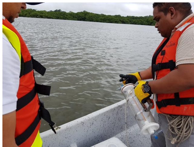
Fig. 3. Tubo Van Dorn usado para la toma de muestras
