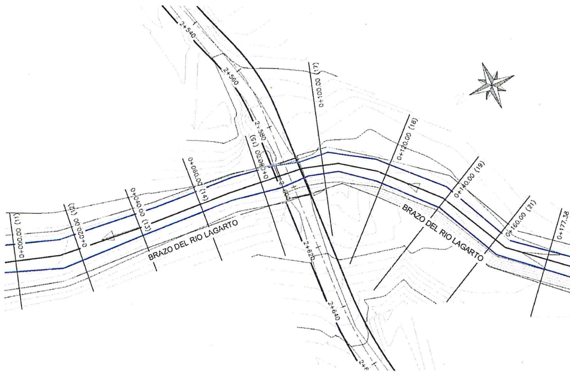
La Figura 7 - Muestra la localización en planta de las secciones transversales del tramo del cauce de Brazo del Rio Lagarto usadas en los cálculos hidráulicos.
