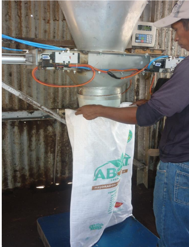
Figura 12. Empacado con dosificadora
