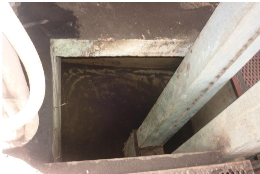
Figura 10. Depósito del compost tamizado, de allí es elevado para caer en el reservorio de la dosificadora
