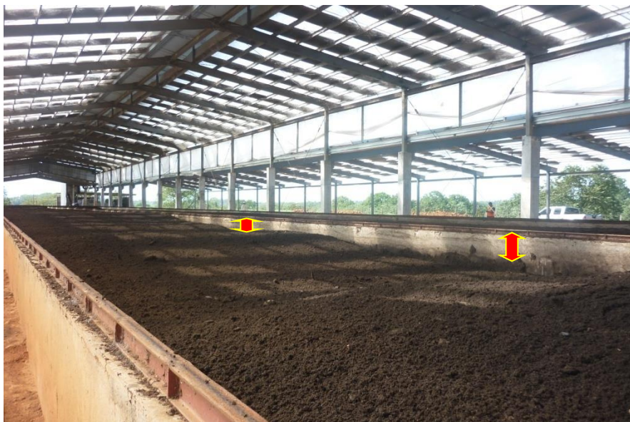
Figura 7. Características del material al avanzar en la hilera, la variación del volumen se puede observar en el nivel que alcanza la pila en el borde del muro, se espera una reducción hasta de un 50 % del volumen inicial.
