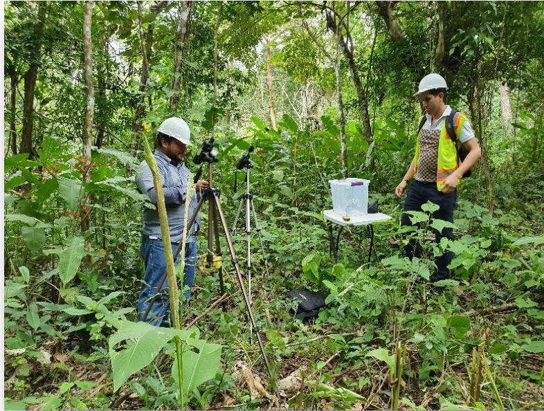
Imagen 7: Toma de muestras de calidad de aire y ruido ambiental Fuente: Laboratorio analítico
