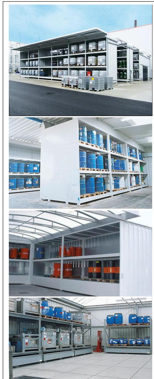
**Figura 2:** Ejemplo de contendores para materiales peligrosos, módulos y su disposición dentro de la galera. Fuente: Promotor.
