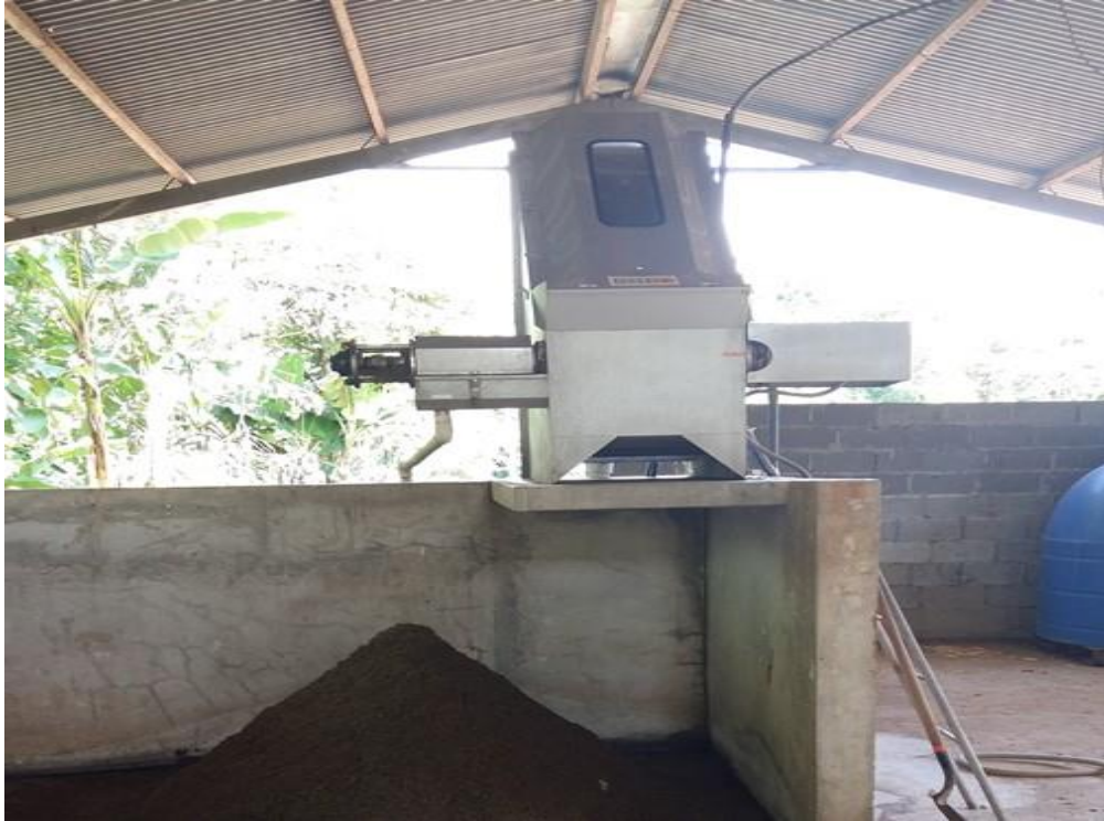
Imagen 3. Separador de sólidos de acero inoxidable con tornillo extrusor.
