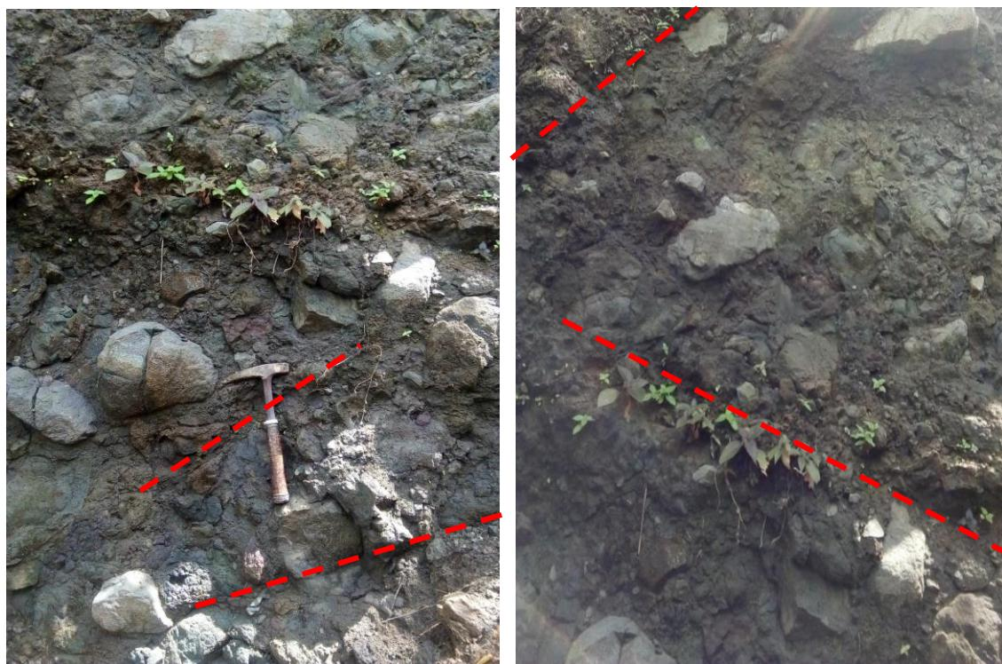
**Figura 5. (a) Talud mostrando un aglomerado volcánico compacto diaclasado según los trazos rojos. (b) Aglomerado volcánico en parte superior del talud.**
