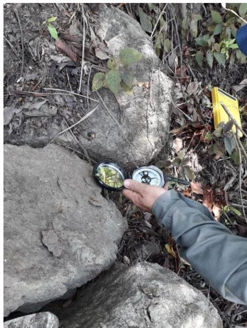
**Figura 4. Afloramiento de andesita de coloración castaña y fracturada.**
