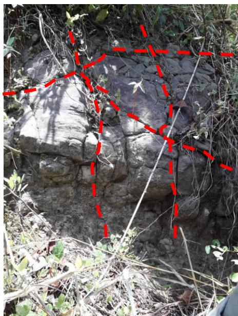
Figura 12. Afloramiento de andesita diaclasada.
