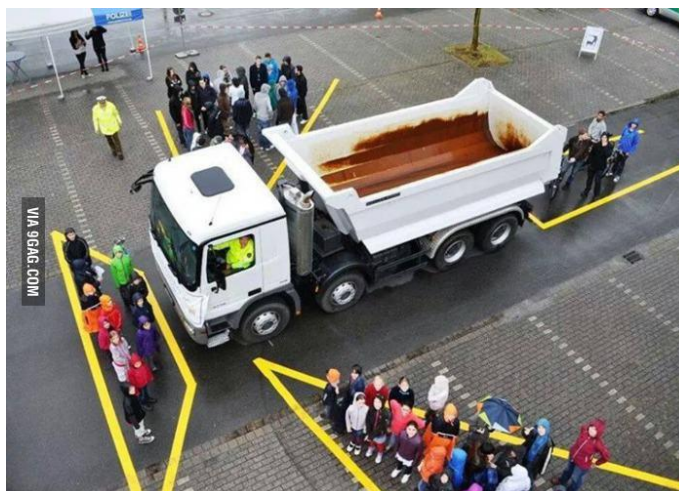
Figura 10.2. Puntos ciegos para el conductor de un camión
