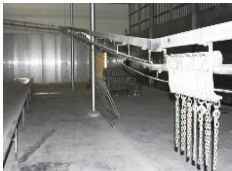
Material: Rieles de acero galvanizado, cadenas y ganchos de acero inoxidable.
