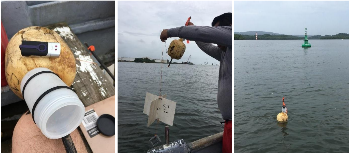
Figura #12. Derivadores de corrientes con GPS empleado en el estudio hidrodinámico de Bahía Las Minas
