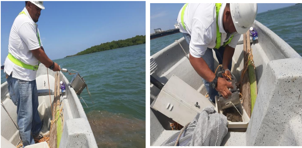
Figura # 14. Toma de muestras de sedimentos con un Draga Ekman para el estudio del Bentos marino
