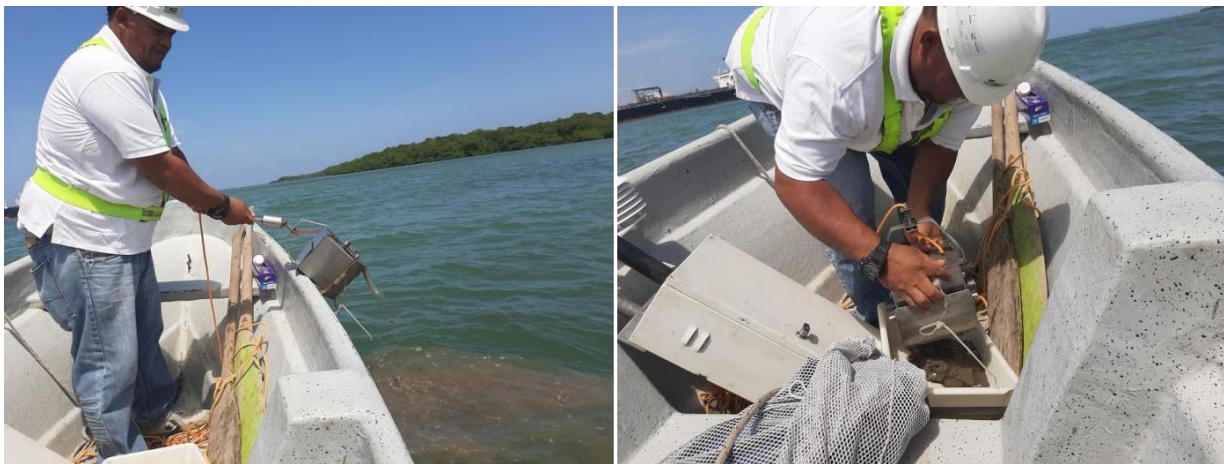
Toma de una muestra -formada por tres réplicas- de sedimentos con una draga Ekman para el estudio del bentos marino.
