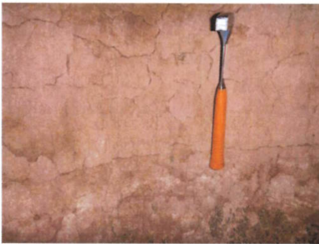
Figura 4. Unidad sedimentaria (Limolitas) con capacidad de soporte muy mala (Torre 1).
