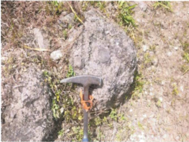
Figura 6. Unidad volcánica (Lahar) compacto con fragmentos caóticos y bien soldados buena capacidad de soporte.
