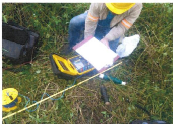
Figura 3. Medición de Resistividad Eléctrica del Terreno.
