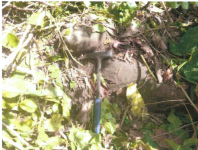
Figura 11. Unidad Sub-Intrusivo (Diorita) bloques rodados, duro compacto levemente meteorizado con capacidad de soporte buena.
