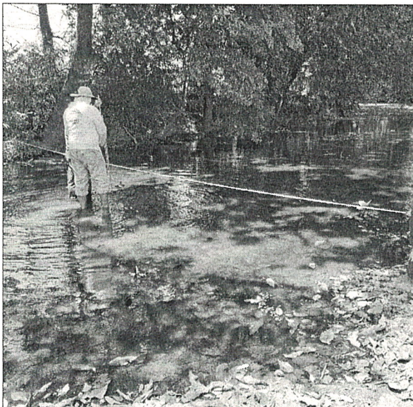
Imagen 5. Personal técnico realizando el Aforo en el río Lajas.
