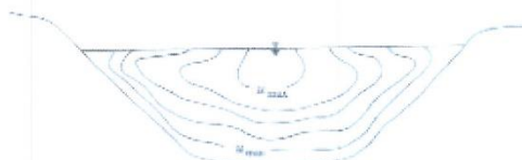
Figura 4. Distribuciones típicas de la velocidad en un canal abierto.
