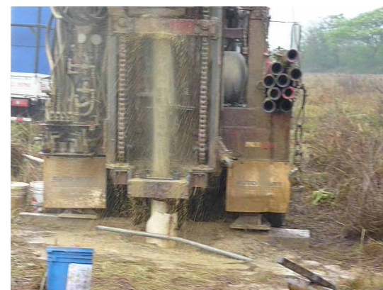
Secuencia de fotos durante las perforaciones, para análisis de cantidad y calidad de agua subterránea.
