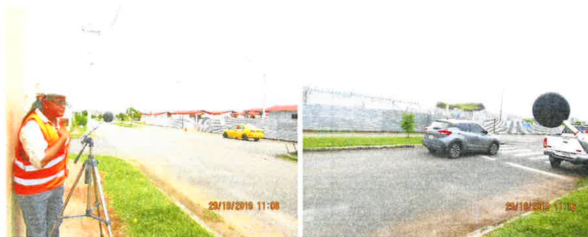
Imágenes 4.1 y 4.2. Equipo de medición de ruido ambiental y fuente de ruido identificada (auto) en el lugar de medición - Calle 3B-1 (P1)
