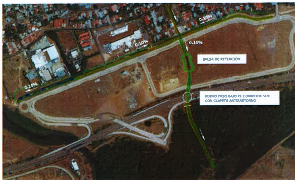
Detalle de los elementos constituyentes de la solución de drenaje general de la zona sur de Ciudad Radial y Metro Park. Zona Oeste.
