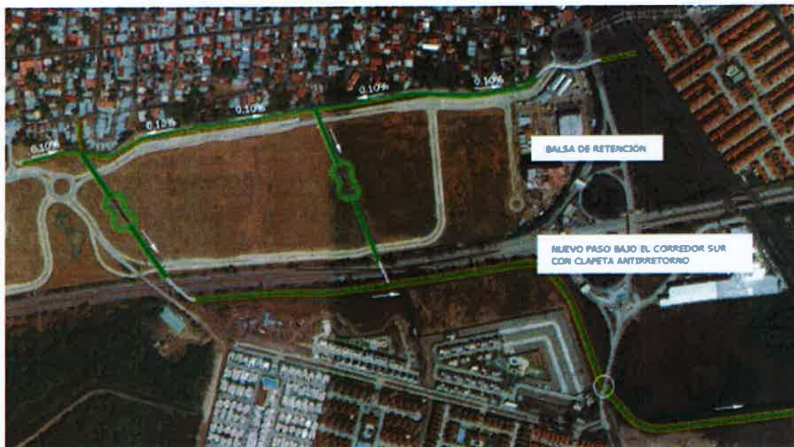
Detalle de los elementos constituyentes de la solución de drenaje general de la zona sur de Ciudad Radial y Metro Park. Zona Este.
