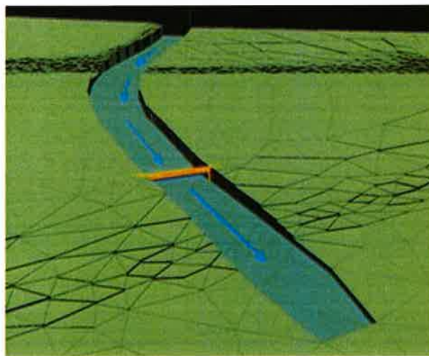
Canal de drenaje a través del Corredor Sur y compuerta anti-retorno situada en la zona próxima al manglar donde se realizará el vertido libre del drenaje.
