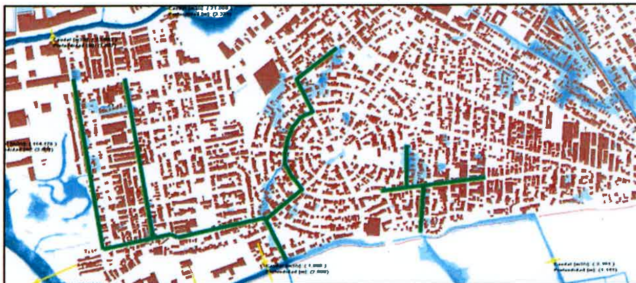
Representación esquemática de la red de colectores (líneas verdes) en la zona urbana de Ciudad Radial. Drenaje de la zona de Santa Inés hacia canal de Metro Park.
