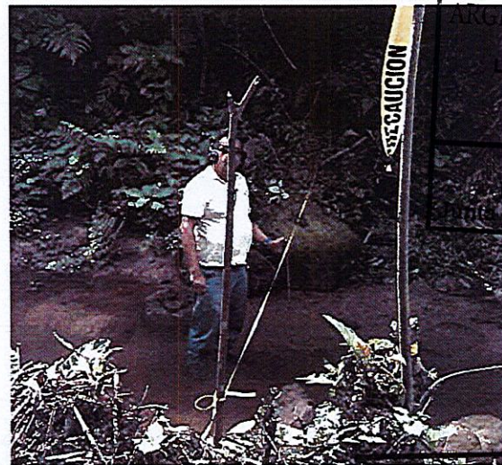
Foto N° 4 Proceso de aforo por vadeo
