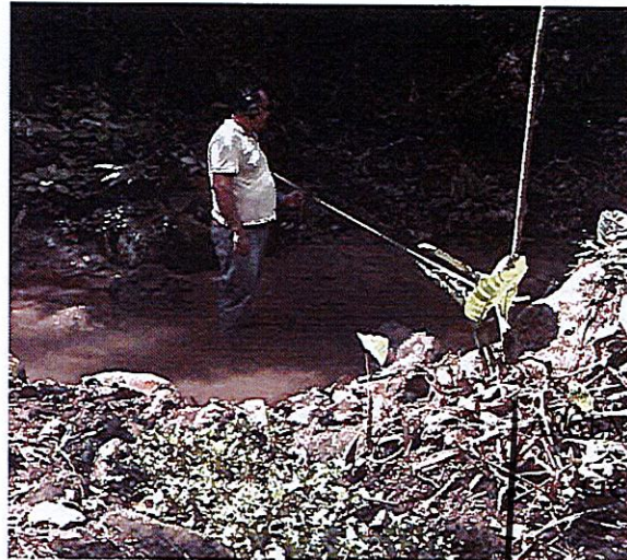
Foto N° 5 Proceso de aforo por vadeo
