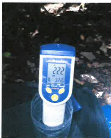
Fig.27 y 28, Conductividad eléctrica ( \mu Siemens/cm) y sólidos totales disueltos (STD) en mg/l del agua de escorrentía sub superficial
