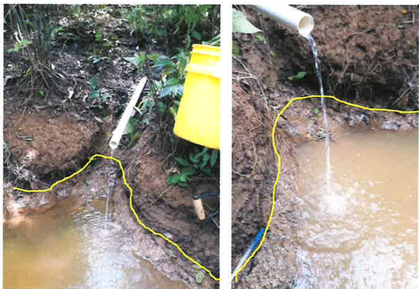
Figuras 17 y 18- Ilustración fotográfica, donde se observa el perfil de suelo hasta su base, humedecida por el flujo sub superficial (línea amarilla), dicho basamento semi impermeable se asocia a una arenisca tobácea de matriz granular fina (ver abajo esquema de perfil de suelo: relación acuífero principal vs flujo sub superficial).
