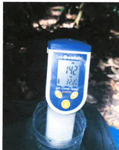
Fig.27 y 28, Conductividad eléctrica ( \mu Siemens/cm) y sólidos totales disueltos (STD) en mg/l del agua de escorrentía sub superficial
