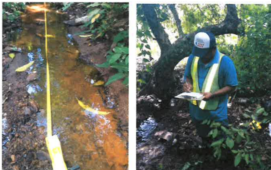
Figuras 15 y 16, se ilustra el dimensionamiento del aforo con el método del flotador y el correspondiente registro de datos (Caudal Q = \text{Velocidad del flotador} \times \text{área de sección transversal} \times 0.85 \text{ factor de corrección} ).
