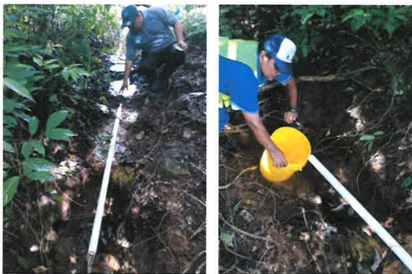
Figuras 13 y 14- Ilustración fotográfica del aforo del flujo sub superficial (Método volumétrico-tiempo de llenado de un recipiente de 5 galones), se registró un caudal total de 7.5 gpm.
