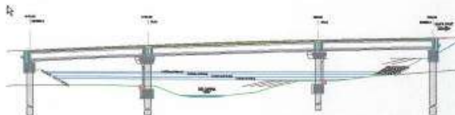
Figura 14.- Sección del puente con alturas de lámina de agua
