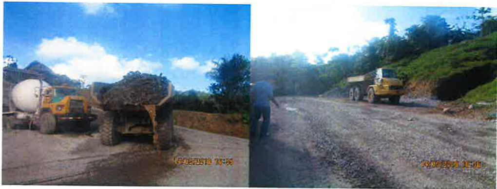
Momento en que volquete articulado de aproximadamente 12-22 m3 de capacidad de carga, sale de la zona 6 recién cargado de grava de río y se dirige hacia el actual punto de acopio (después de zona 6) hacia Conquista del Atlántico. Observe chorro de agua producto de la recién extracción.
