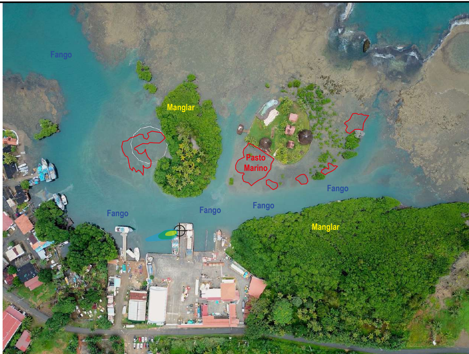
Figura 63) Vista de la pluma de dispersión del efluente en Llenante
