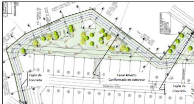
Imagen 8: Extracto del pre-diseño del drenaje pluvial "Sin Nombre 2", donde se ilustra las secciones de Cajón y Canal abierto en concreto.
