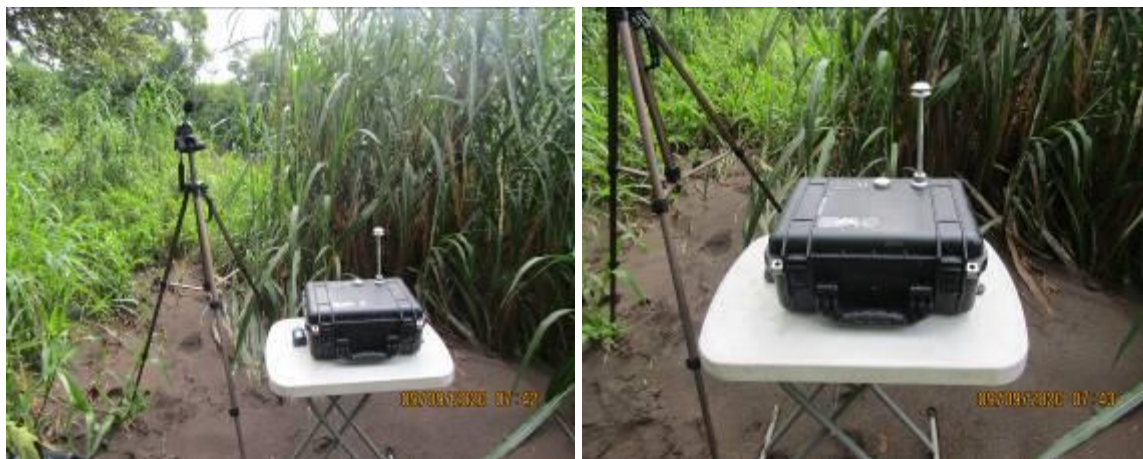
Imágenes 11 y 12. Vista del equipo durante la medición de PM 10 en el Punto 2: Camino a rehabilitar
