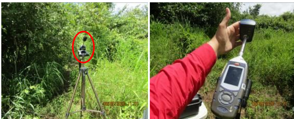
Imágenes 5 y 6. Equipo de medición de ruido ambiental colocado en el Punto 1: Próximo al área de captación
