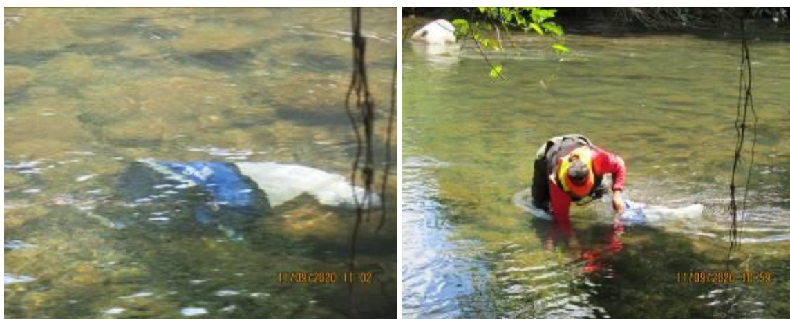
Imágenes 33 y 34. Red Surber utilizada para captura de organismos bentónicos (insectos, larvas y otras formas acuáticas de vida libre)
