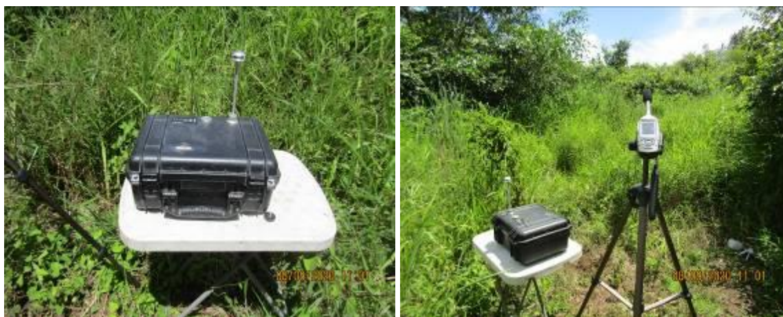
Imágenes 9 y 10. Vista del equipo durante la medición de PM_{10} en el Punto 1: Próximo al área de captación
