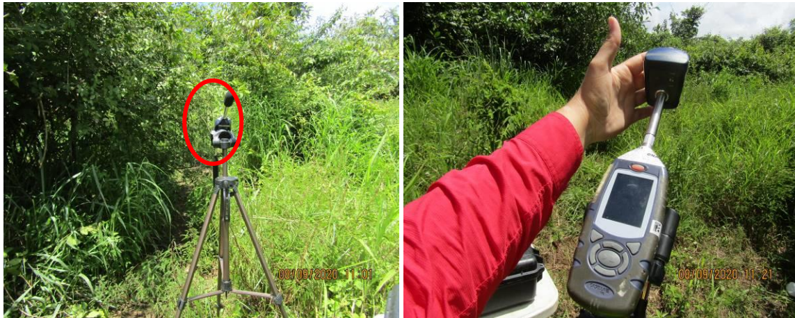
Imágenes 4.1 y 4.2. Equipo de medición de ruido ambiental colocado en el Punto 1: Próximo al área de captación
