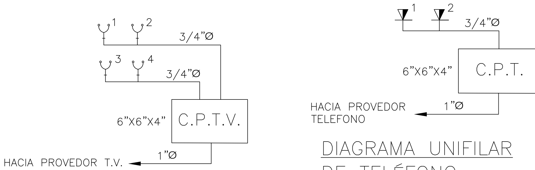
DIAGRAMA UNIFILAR DE T.V.
