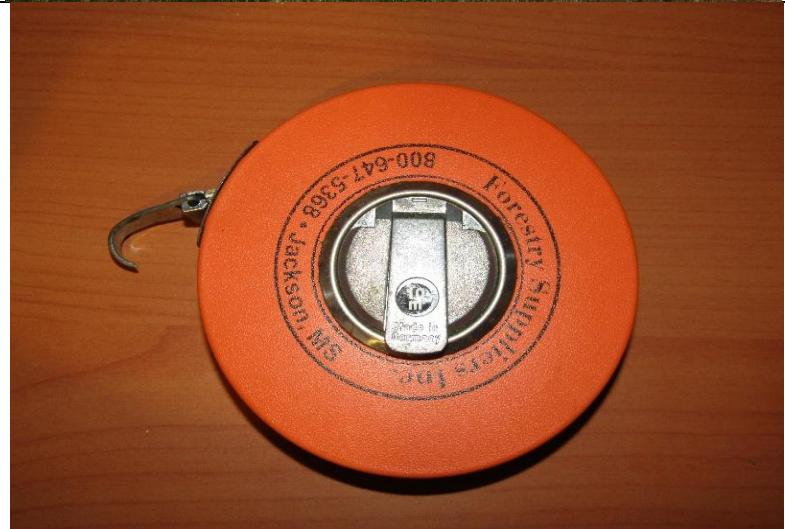
Cinta diamétrica utilizada para medir el DAP
