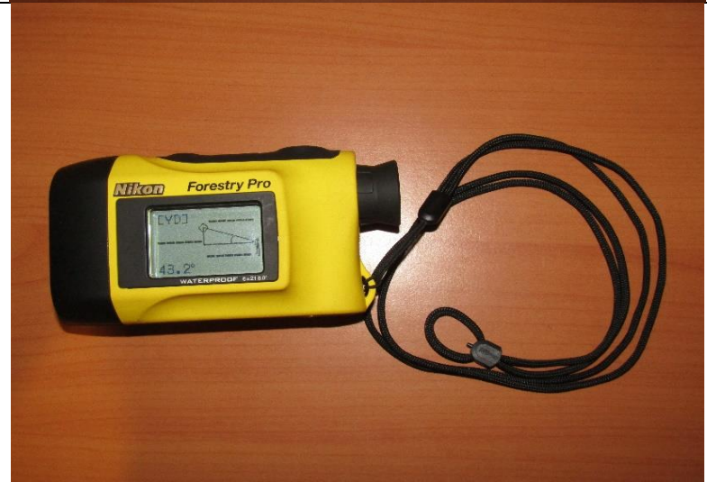
Hipsómetro a laser Nikon Forestry Pro utilizado para el cálculo de alturas de los árboles
