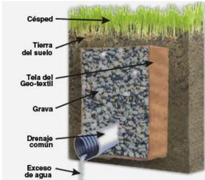
Figura 15. Detalle típico de drenaje francés (Fuente: https://www.pinterest.com.mx )
