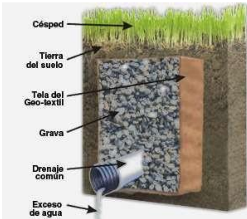
Figura 15. Detalle típico de drenaje francés (Fuente: https://www.pinterest.com.mx )
