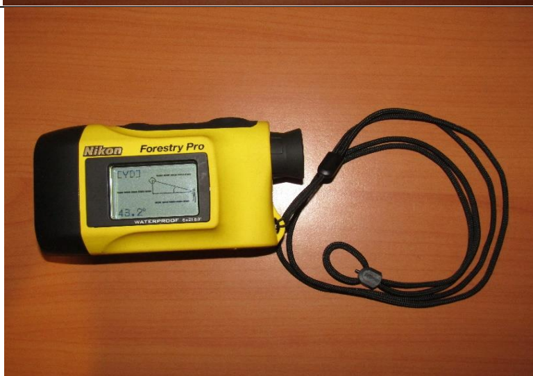
Hipsómetro a laser Nikon Forestry Pro utilizado para el cálculo de alturas de los árboles
