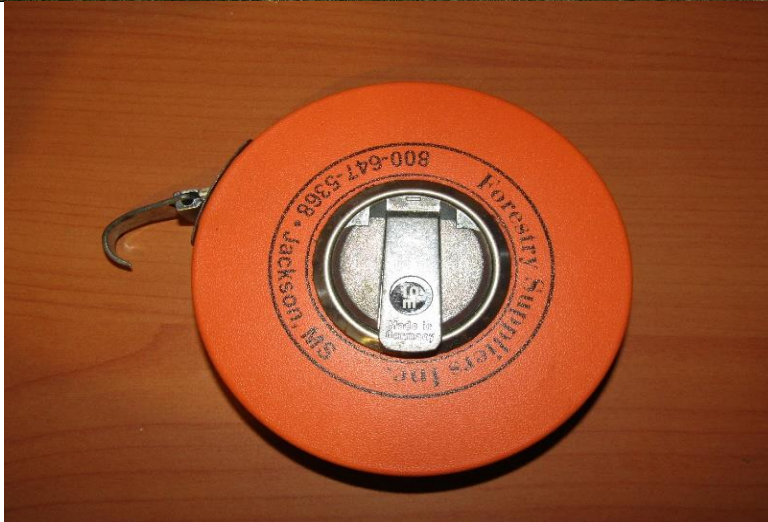
Cinta diamétrica utilizada para medir el DAP
