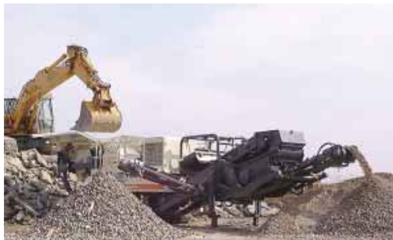
Una LT95S triturando concreto reciclado en Alemania.
