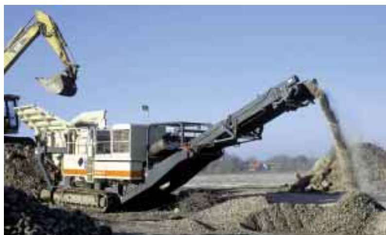
El robusto transportador principal puede llevar un separador magnético opcional para aplicaciones de reciclaje.
