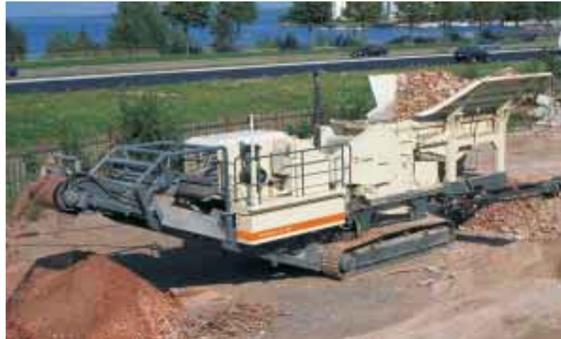
Una planta Nordberg LT105 en una obra de reciclaje en el centro de una ciudad en Finlandia.
