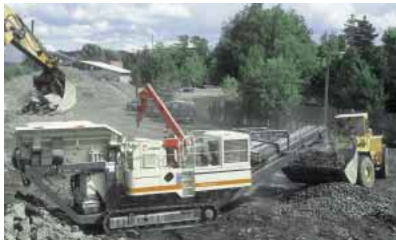
La LT95 incorpora Nordberg IC500. Este sistema controla y ajusta todos los parámetros clave del proceso optimizando resultados.
