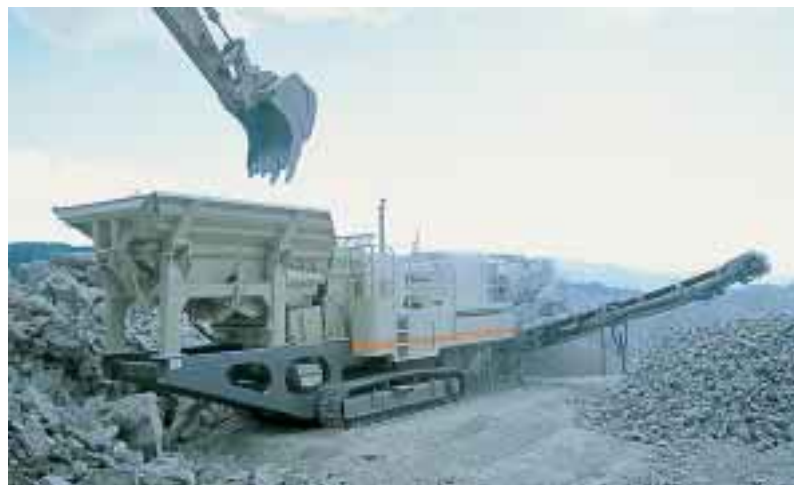
El transportador lateral de la Nordberg LT105S es fácil de ladear para el transporte.
