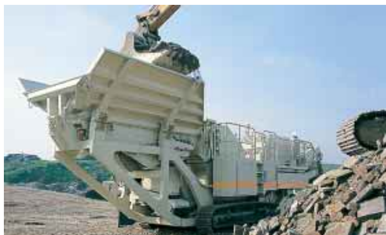
Las robustas tolvas en todas las plantas de trituración Nordberg Serie LT son fabricadas en acero de alta calidad resistente al desgaste.
