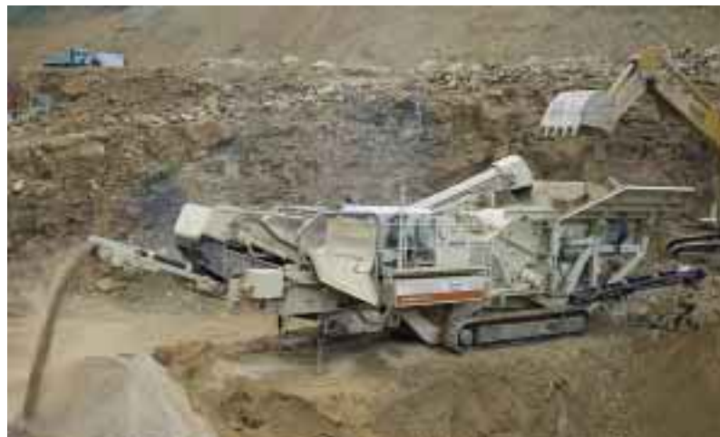
Una LT1213S triturando y cribando piedra caliza en Francia.
