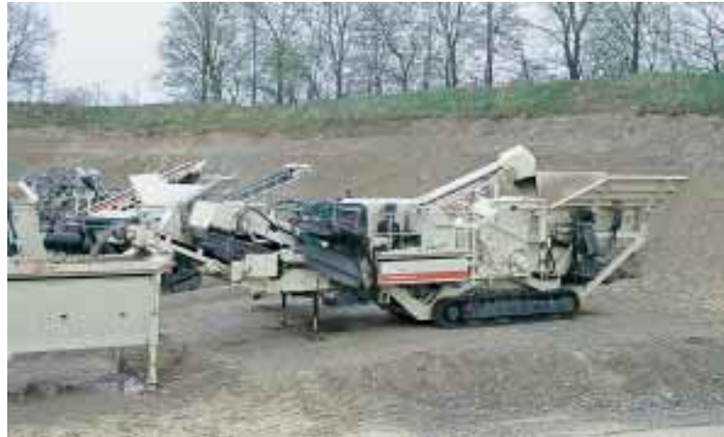
Usada en circuito cerrado, la LT1213S produce un producto final exactamente calibrado.
