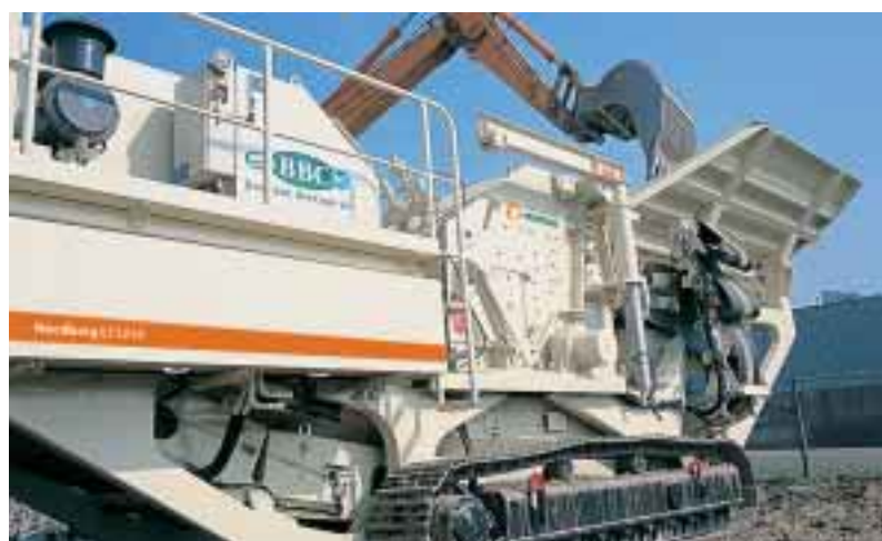
La nueva trituradora especial de impactos Nordberg NP1213M ha sido desarrollada para la planta de trituración móvil Nordberg LT1213.
