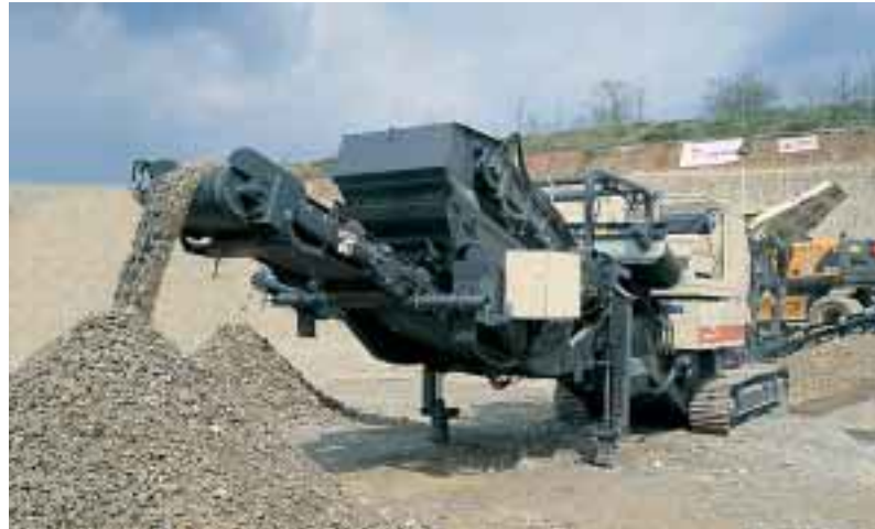
La criba desmontable de la LT95S asegura una eficiente clasificación de los materiales triturados en productos finales limpios.
