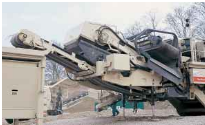
La criba de la LT1213S es fácil de abrir para mantenimiento y cambio de la malla de cribado, mediante el sistema hidráulico.
