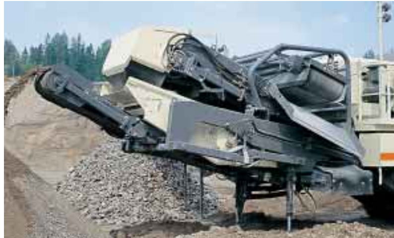
La unidad de cribado puede ser separada en pocos minutos, permitiendo usar la Nordberg LT105S como una unidad normal de trituración primaria.
