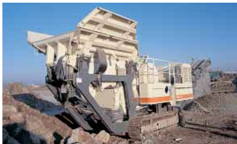
Otra característica sin igual de la Nordberg LT95 es el mecanismo de seguro automático del alimentador, el cual reduce el tiempo necesario para preparar el equipo para el transporte.
