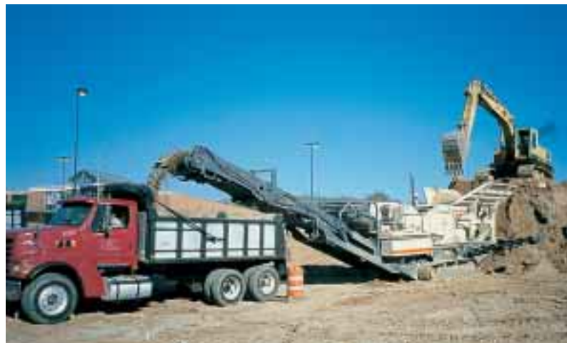
Una LT105 equipada con un transportador extra largo de 12 metros, triturando en los EE.UU.
