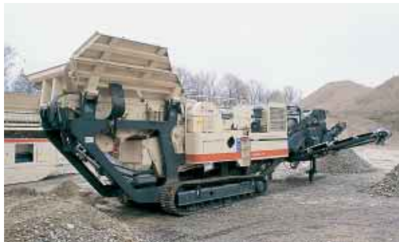
Se pueden usar las robustas tolvas de acero Hardox de 4 m 3 o 6 m 3 de capacidad con la LT95S.
