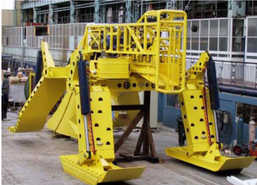
MD3 Jetting Plow 0 - 1.5m Enterramiento 40 toneladas de remolque
