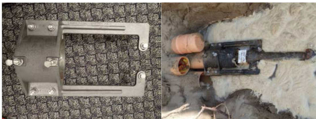
Figura 19: Adaptador de conducto típico para tubería dividida
