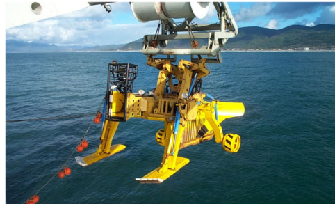
Figura 11: Maquinarias para Enterramiento e inspecciones de cable – Tipo Arado
