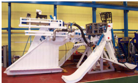
Figura 11: Maquinarias para Enterramiento e inspecciones de cable – Tipo Arado
