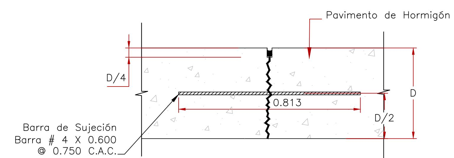
JUNTA LONGITUDINAL DE CONSTRUCCIÓN
