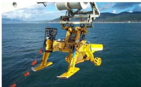
Figura 15: Maquinarias para Enterramiento e inspecciones de cable – Tipo Arado
