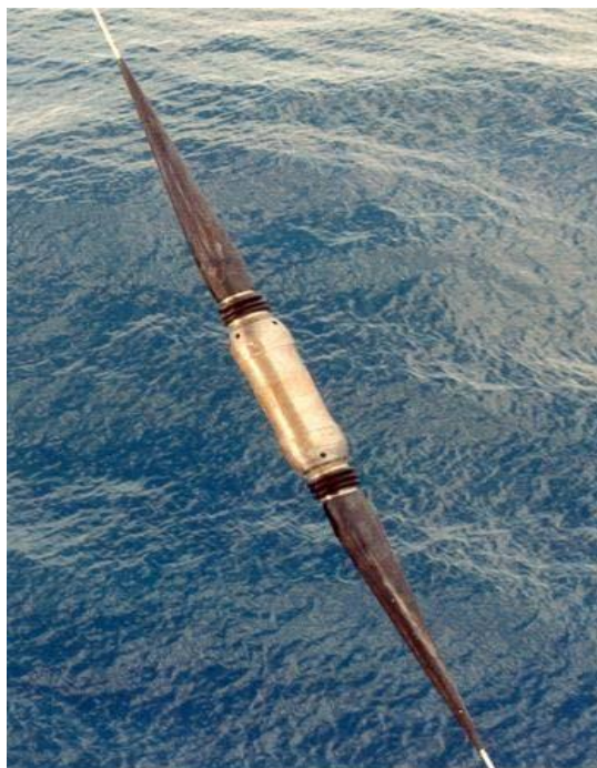
Figura 8 Nodos o “Branching Units” (BUs)
