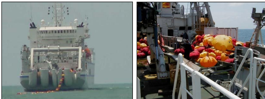
Figura 12: Instalación Marina Atraque Directo de Buque Cablero
