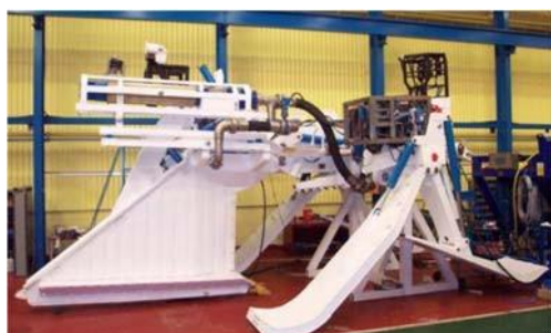
Figura 15: Maquinarias para Enterramiento e inspecciones de cable – Tipo Arado
