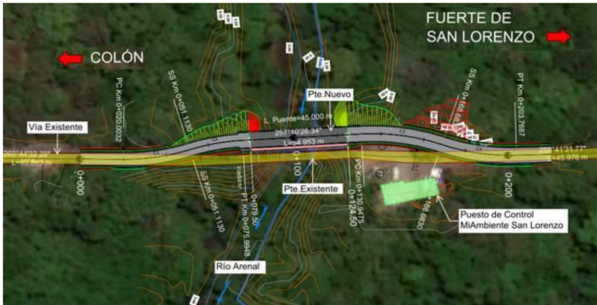
Figura 5.6. Realineamiento del puente sobre el Río Arenal.
