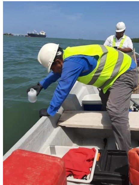
Medida in situ de parámetros físico-químico con sonda multiparamétrica y toma de muestras de agua
