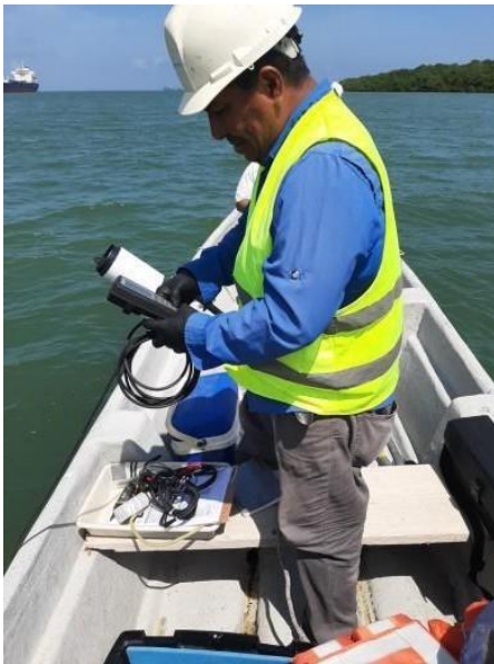
Medida in situ de parámetros físico-químico con sonda multiparamétrica y toma de muestras de agua
